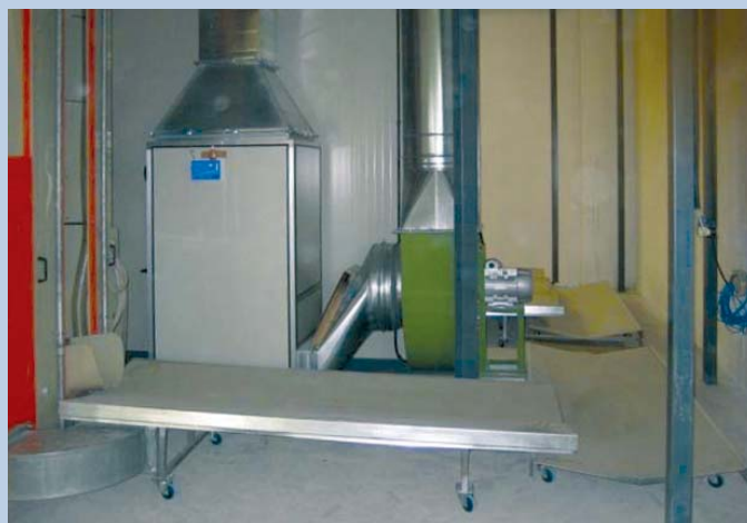
4 – Il sistema di raccolta e rilancio dell'eccesso di impregnante nel flow-coating. 4 – The system for collecting and re-using the excess filler in the flow-coating.
