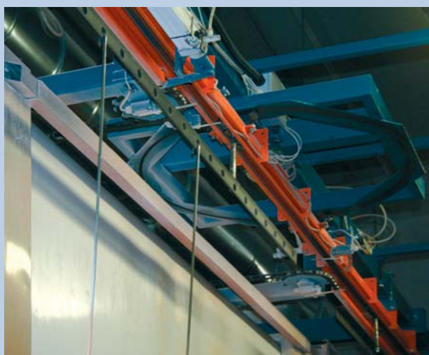
1 – Dettaglio del sistema che permette di girare le barre portapezzi davanti alla cabina di verniciatura.
