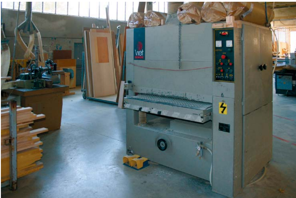
7 – La levigatrice automatica. E' l'ultima fase del processo di costruzione e la prima del processo di verniciatura. 7 – The automated honing machine. This is the last phase of the construction process and the first of the coating process.
