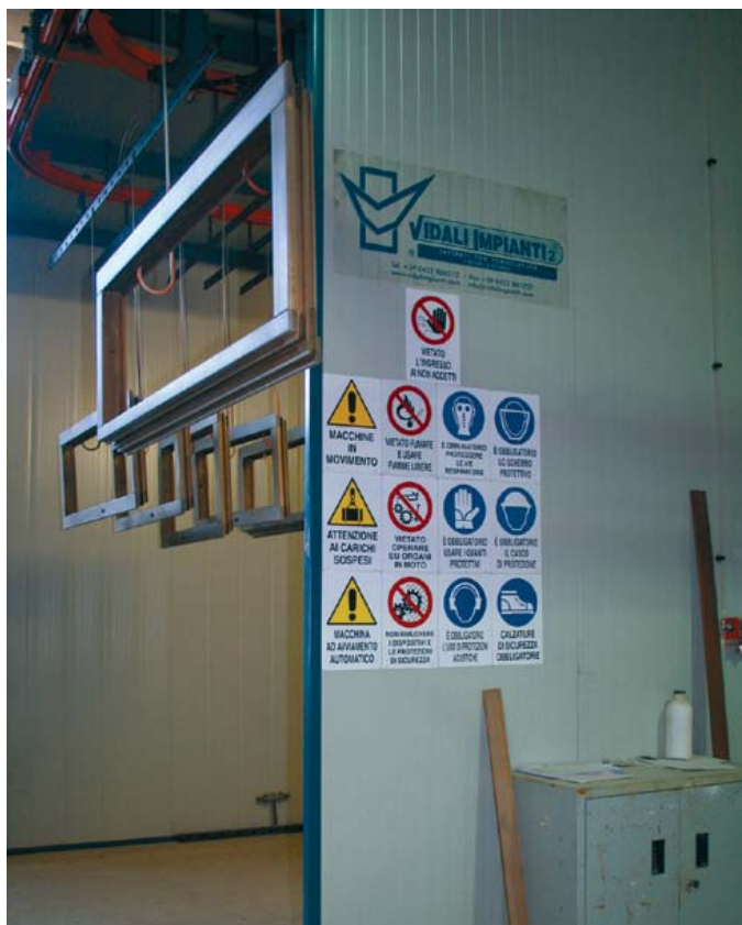
17 e 18 – All'ingresso dell'essiccatoio le bilancelle si dispongono in modo trasversale. L'essiccatoio è mantenuto ventilato, a temperatura ambiente. 17 and 18 – The transversal arrangement of the racks at the entrance of the drier. The drier has fans, and is at room temperature.
