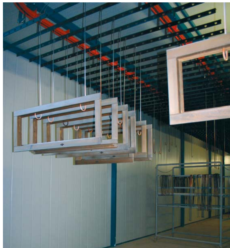
17 e 18 – All'ingresso dell'essiccatoio le bilancelle si dispongono in modo trasversale. L'essiccatoio è mantenuto ventilato, a temperatura ambiente. 17 and 18 – The transversal arrangement of the racks at the entrance of the drier. The drier has fans, and is at room temperature.
