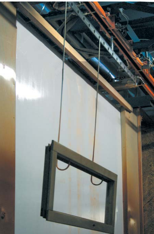
14, 15 e 16 – Nella sequenza si mostrano i reciproci movimenti di rotazione del pezzo e di spostamento della parete di recupero della cabina.
