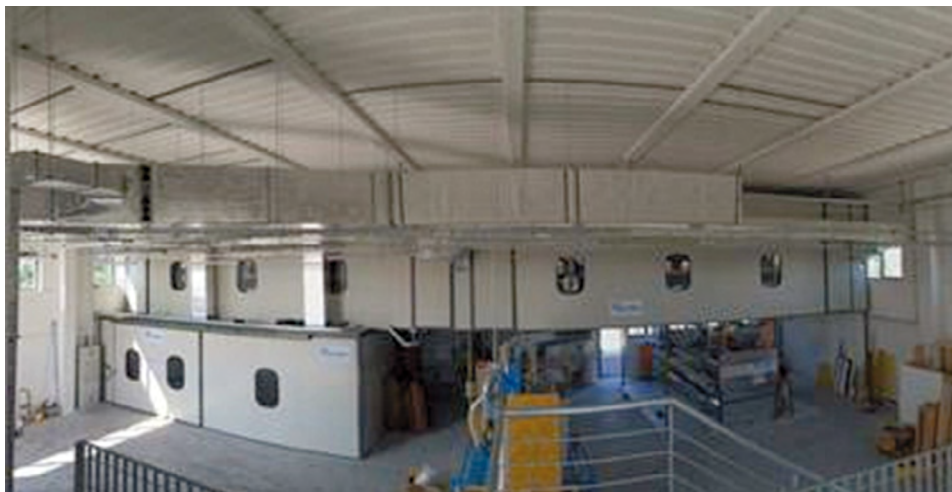
2 – Vista generale dell'impianto, costituito da due cabine, di cui una pressurizzata. E' da notare che il forno di essiccazione dove sostano i vassoi è posizionato sopra le due cabine: in questo modo viene sfruttata l'altezza dell'edificio.
