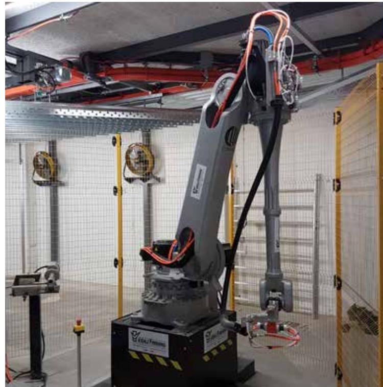
La productivité horaire est supérieure à celle de l'homme car les temps de montée et de descente de l'opérateur pour atteindre les parties plus hautes des pièces accrochées sont éliminés . En exploitant au maximum la hauteur utile de l'installation , la capacité de l'installation augmente .
