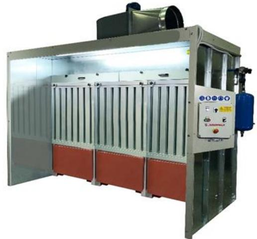
La cabina di questo tipo è indicata per l'aspirazione ed abbattimento delle polveri prodotte dalla carteggiatura di materiali metallici ferrosi. È assolutamente vietato carteggiare alluminio, magnesio e altri materiali esplosivi.
