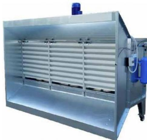
Le caratteristiche principali di questa cabina sono le dimensioni ridotte e la possibilità di facile trasferimento. Questo ci permette di utilizzarla anche in locali con scarsa altezza, spostarla in base alle nostre esigenze e, se necessario, orientarla intorno all'oggetto da carteggiare.
