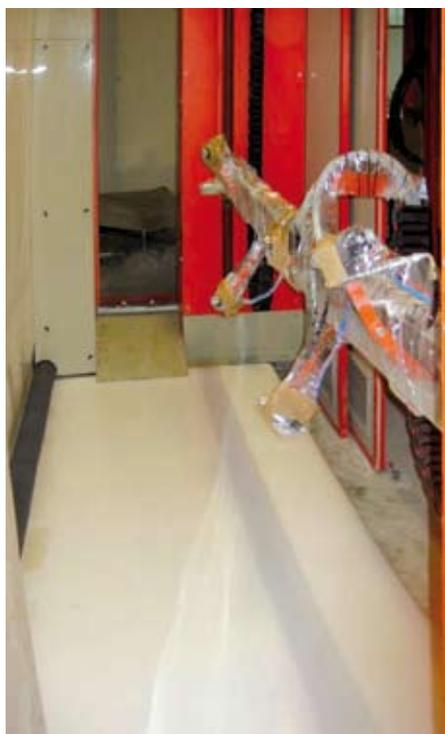
7- L'interno della cabina di verniciatura con il tappeto di recupero delle vernici.
