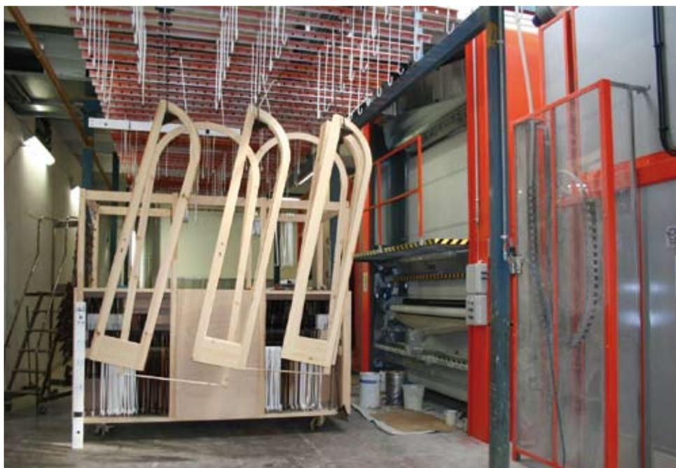
10 - Il tunnel di asciugatura ad aria calda.
