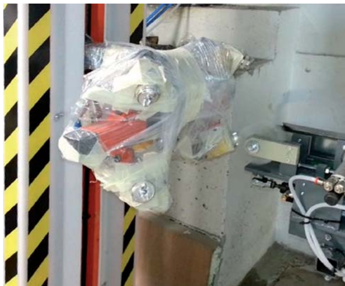
4 - Le 5 pistole air-mix indipendenti: sono visibili 2 dei 4 ugelli inclinati per l'applicazione della vernice sui bordi e quello centrale per la spruzzatura in linea retta. The 5 independent air-mix spray-guns: 2 of the 4 inclined nozzles are visible for applying the coating on the edges and the central one of spraying in a straight line.
