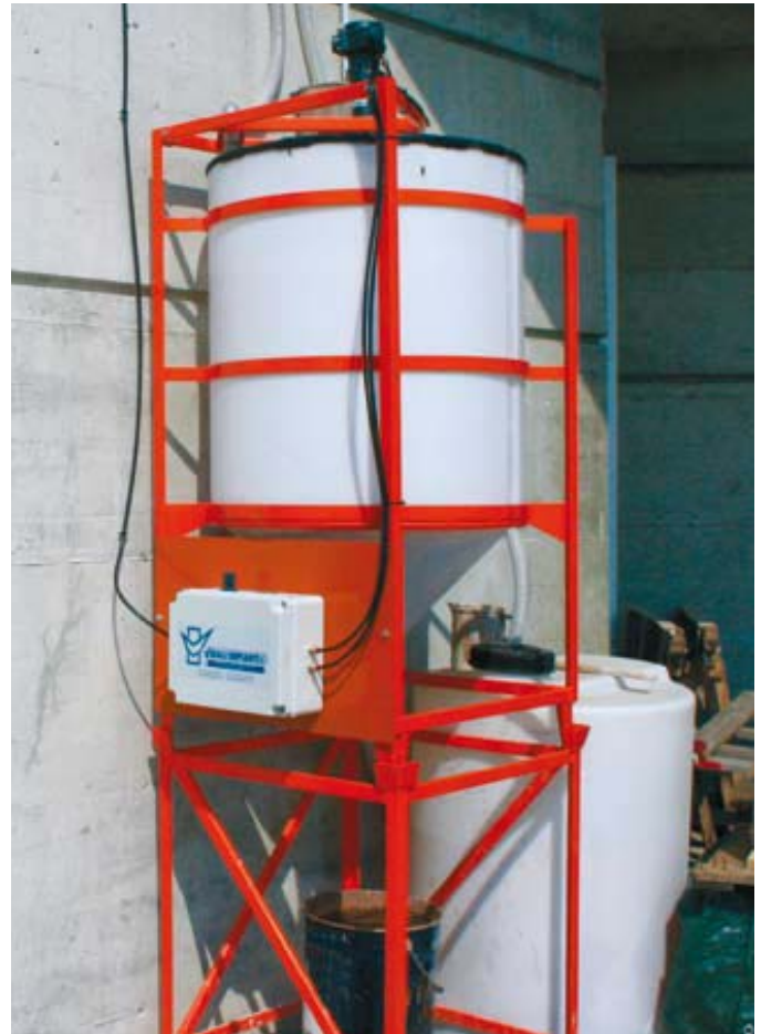
8 - Il chiarificatore delle acque di cabina: permette il trattamento e riciclo per lunghi intervalli di tempo dell'acqua di captazione dell'overspray, e di smaltire solamente i solidi, separati e concentrati. 8 - The clarifier for the water coming from the booth: it allows treating and recycling, for long time intervals, the water that collects the overspray, as well as disposing of separated and concentrated solids only.
