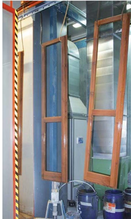
8 – Un altro momento della fase di finitura: uscita dei serramenti trasparenti dalla cabina di spruzzatura. Another moment within the finishing step: the transparent fixtures exit the spraying booth.
