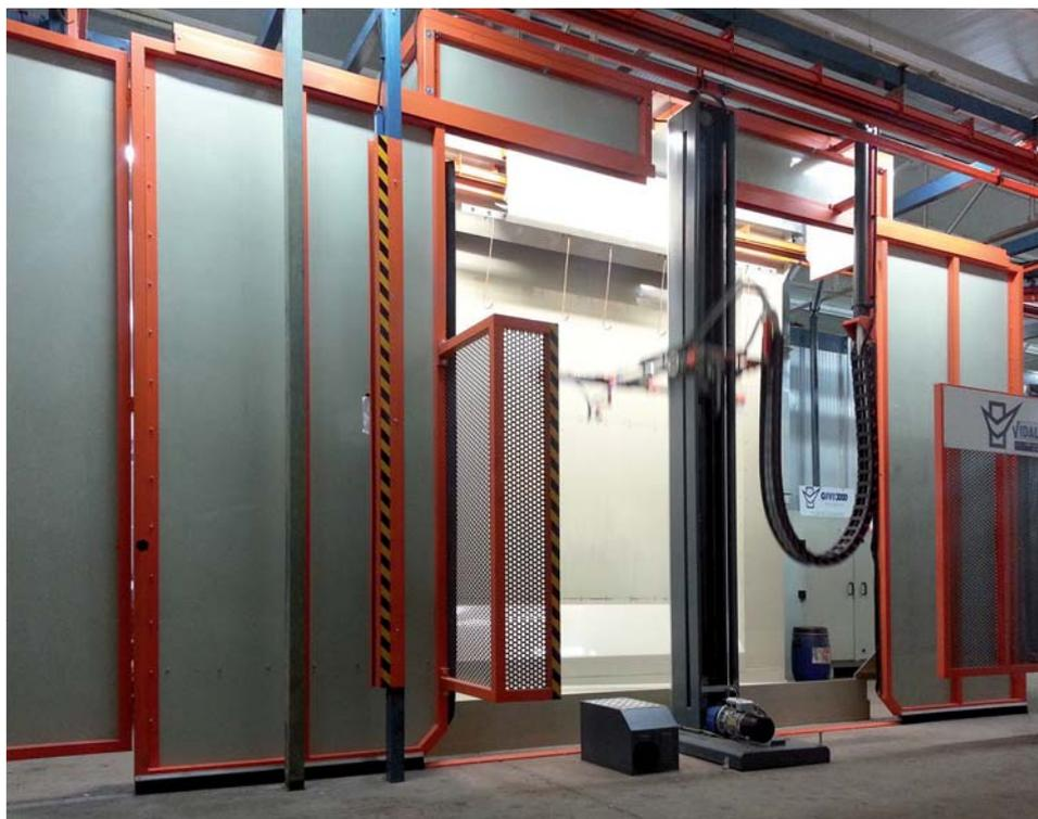
**12 - Particolare dell'impianto di aspirazione: l'unità filtrante posta ad altezza uomo consente un accesso rapido per gli interventi di manutenzione e pulizia.**
