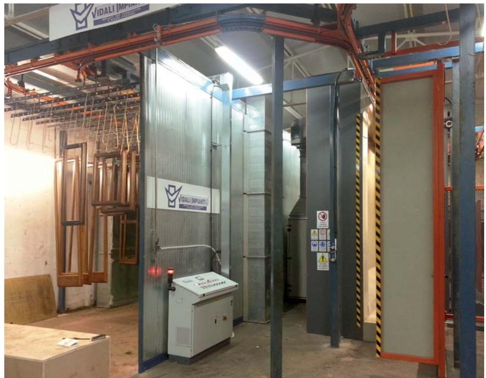
nelle cave. La verniciatura è di tipo elettrostatico a carica diretta: questo sistema permette di aumentare notevolmente il coefficiente di trasferimento della vernice dalle pistole al pezzo (fig. 11).
