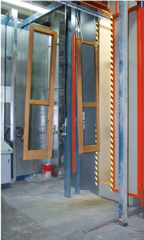
7 – Gli infissi pronti per la finitura entrano nel tunnel dell'impianto GIVI 3000 Plastic. The frames ready to be finished enter the tunnel of the plant GIVI 3000 Plastic.
